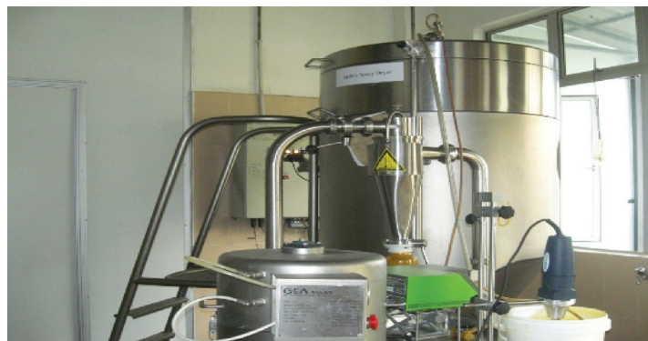
Gambar 1. Teknik pengeringan semburan (spray drying)
