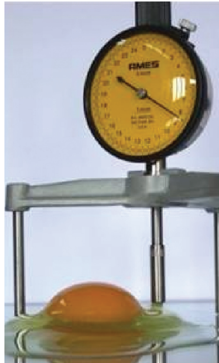
Gambar 4. Pengukuran ketinggian albumen menggunakan mikrometer AMES S-6428
