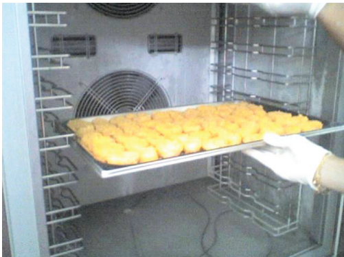
Gambar 3. Proses penyejukbekuan menggunakan mesin blast freezer
