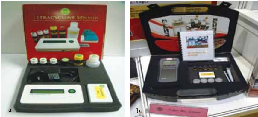
Gambar 1. Antara hasil penyelidikan MARDI yang menggunakan teknologi nano. (a) Kit pengesanan sisa antibiotik di dalam produk daging ayam segar (b) Kit pengesanan aflatoxin B 1
