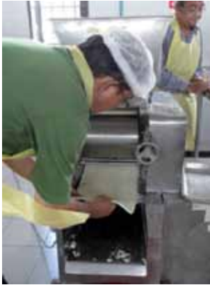
Gambar 1. Proses penyemperitan doh kuetiau
