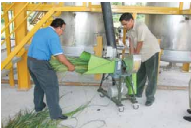
Gambar 2. Daun serai wangi dipotong menggunakan mesin pemotong
