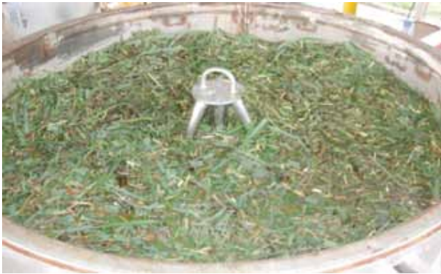
Gambar 3. Daun serai wangi yang telah dipotong dipenuhi di dalam penyuling
