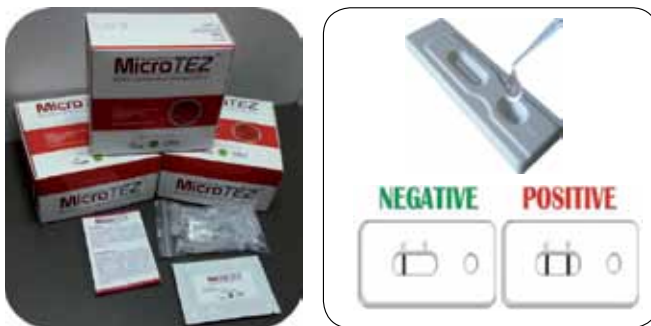
Gambar 1. Contoh kit pengesanan kualitatif (MicroTEZ merupakan kit pengesan bakteria Salmonella di dalam produk makanan)
