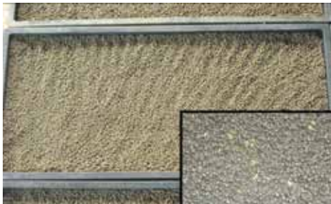
Gambar 2. Granul campuran sekam padi bakar dan elemen baja
