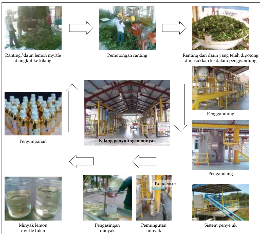
Gambar rajah 2. Penyulingan minyak pati daripada daun lemon myrtle dengan kaedah steam distillation
