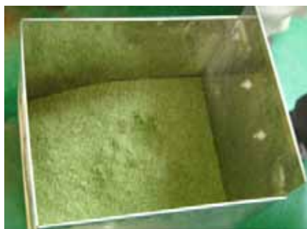
Gambar 3. Daun yang telah dikisar menjadi teh bersaiz 3 mm
