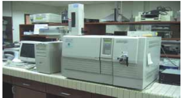
Gambar 1. Kromatografi gas spektrometer jisim (GCMS) yang digunakan bagi tujuan pengesanan indeks kepedasan cili
