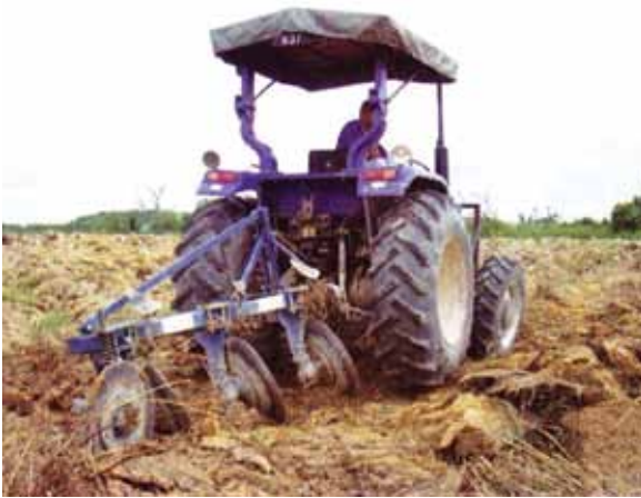
Gambar 2. Operasi bajak piring
