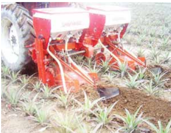
Gambar 8. Mesin merumput di antara batas dan membaja
