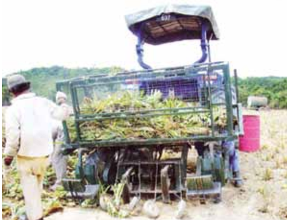
Gambar 5. Operasi mengisi sulur ke dalam bakul mesin penanam
