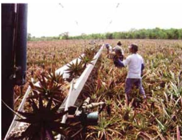
Gambar 10. Operasi menuai buah nanas dengan menggunakan mesin bantuan penuaian
