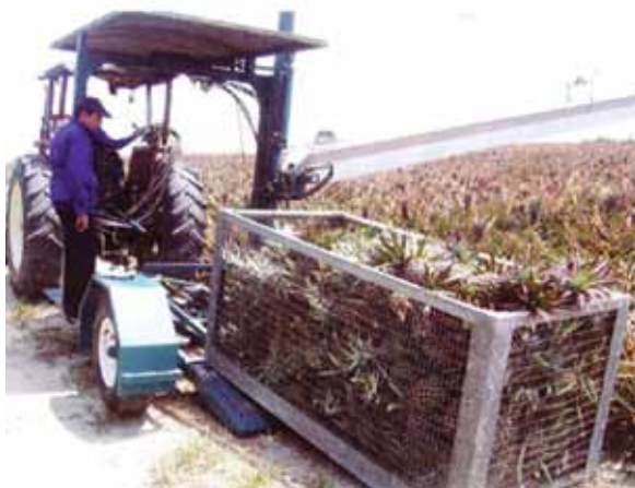
Gambar 11. Operasi menggelongsorkan bakul buah yang telah penuh
