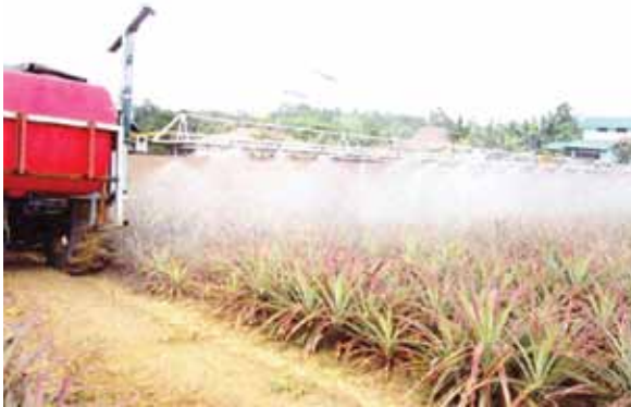
Gambar 7. Operasi penyemburan dengan mesin penyembur berlengan
