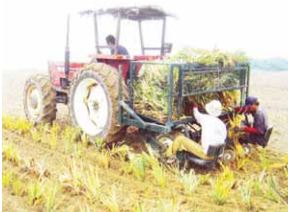
Gambar 4. Operasi menanam nanas secara mekanisasi
