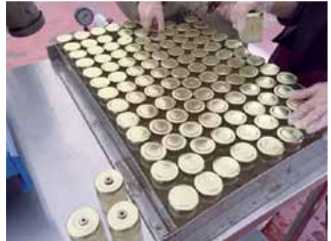
Gambar 5. Botol kaca berisi minuman sarang burung disusun sebelum dimasukkan ke dalam alat retort
