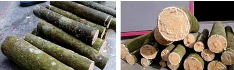
Gambar 2. Batang kayu getah yang telah dipotong dengan pelbagai saiz yang diletakkan di kawasan bersimen untuk mencegah kerosakan
