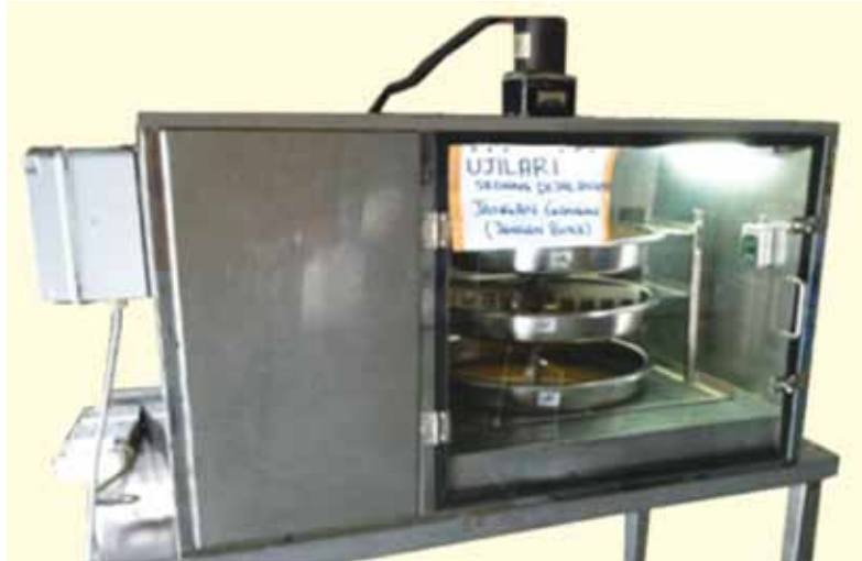
Gambar 4. Prototaip alat penyahidrat madu kelulut MARDI berskala makmal
