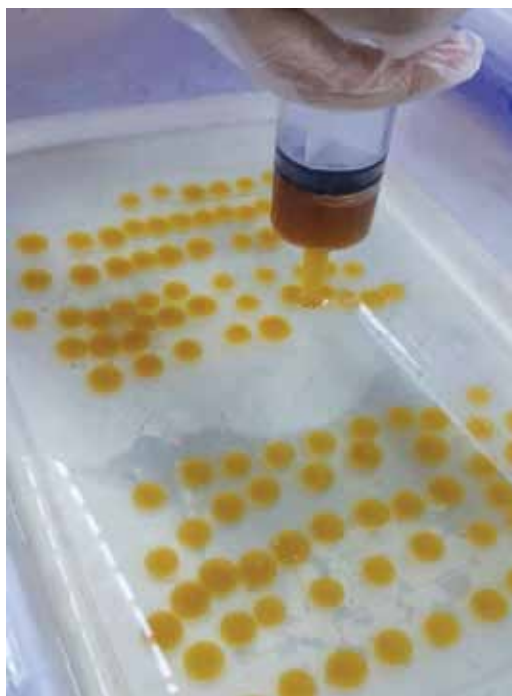
Gambar 2. Pembentukan bebola menggunakan picagari ke dalam larutan alginat
