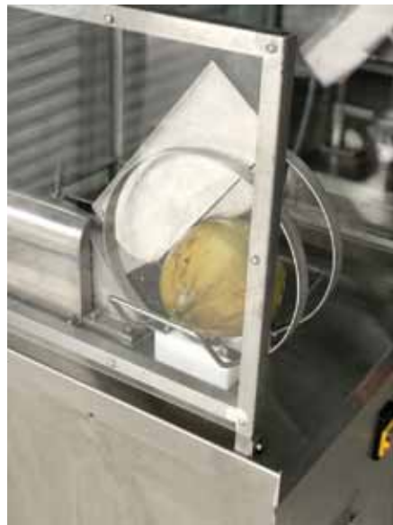
Gambar 4. Operasi belahan dua dan penebukan buah kelapa muda
