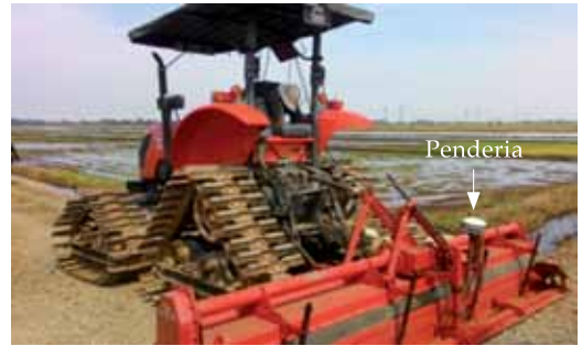
Gambar 1. Pemasangan penderia ketinggian tanah di traktor dan implemen
