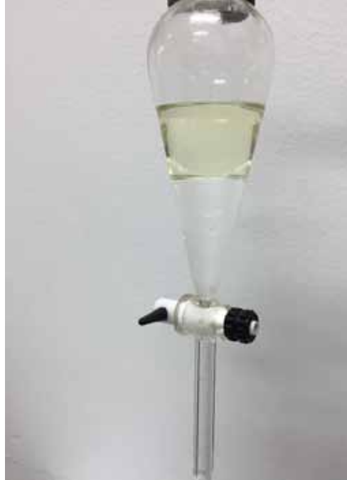
Gambar 4. Proses pengasingan minyak dan air menggunakan turus pemisah
