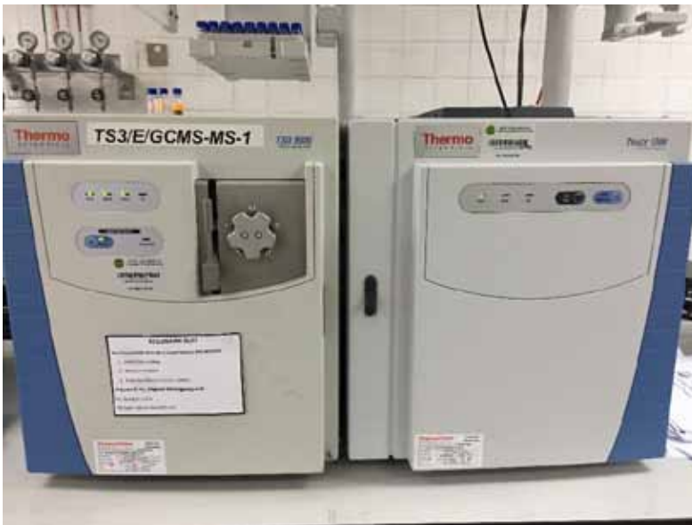
Gambar 6. Peralatan kromatografi gas spektrometri jisim (GCMS) yang digunakan bagi tujuan analisis dan pengenalpastian sebatian kimia dalam minyak gaharu
