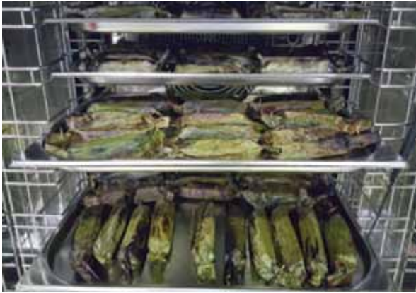
Gambar 6. Penyejukbekuan pantas menggunakan penyejuk beku bagas
