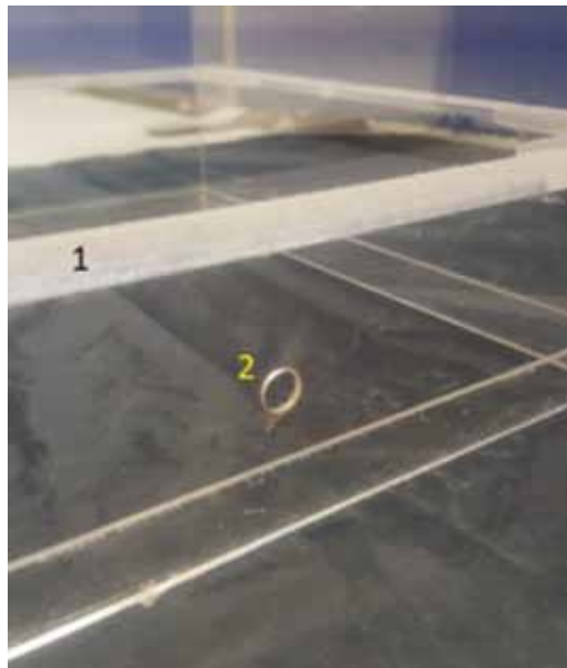
Gambar 6. (1) Kolar, (2) Salur keluar/masuk air
