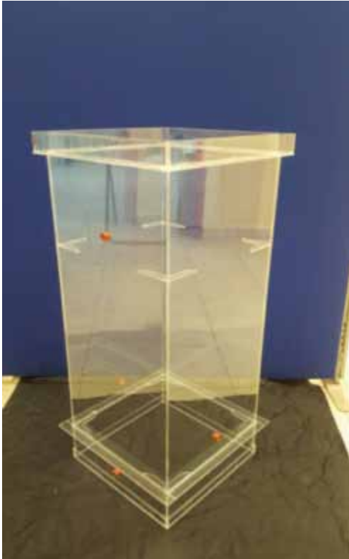
Gambar 3. Bagian badan kebuk pengumpul gas
