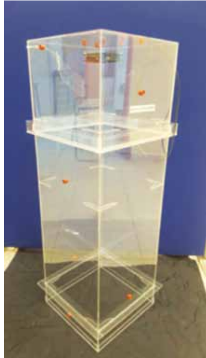
Gambar 1. Kebuk pengumpul gas yang dibangun dan digunakan oleh Pusat BE MARDI
