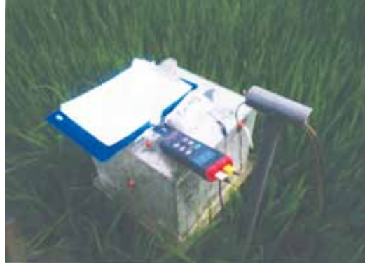
Gambar 10. Penutup kebuk ditutup dan suhu semasa di dalam dan di luar kebuk dicatat
