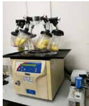
Gambar 2. Contoh sampel yang dikeringkan secara kaedah sejuk dingin beku. Sampel akan dikeringkan selama tiga hari atau sehingga sampel kering sepenuhnya
