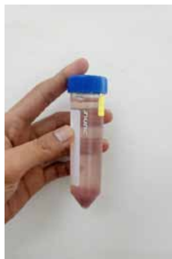
Gambar 3. Dua lapisan terbentuk selepas proses pengemparan. Lapisan atas akan ditapis menggunakan penapis nitrat selulosa 0.45 nm sebelum dianalisis menggunakan HPLC
