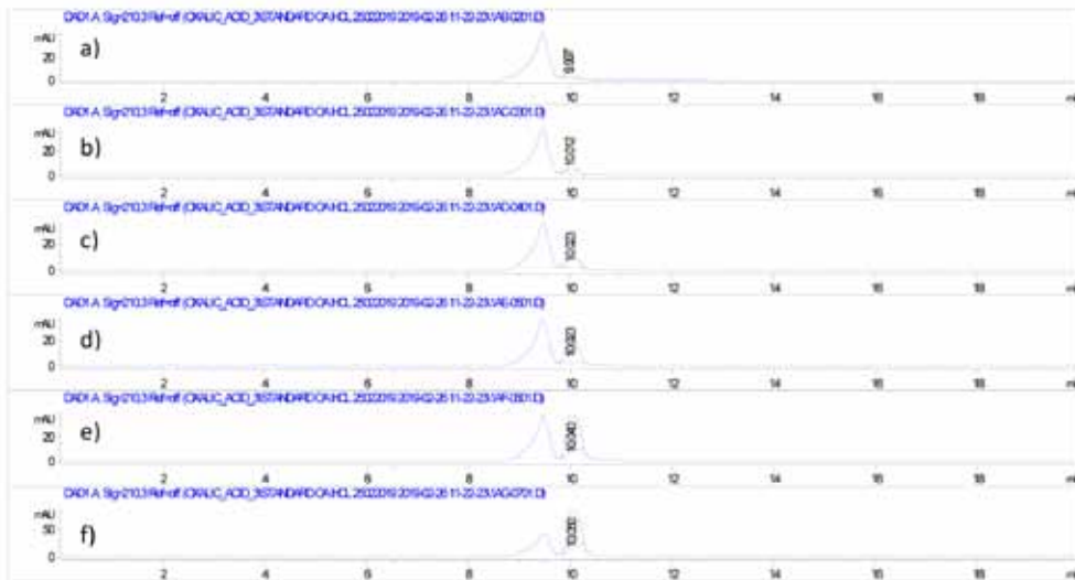
Rajah 2. Masa tahanan (rt) untuk standard asid oksalik dalam larutan HCl pada kepekatan berbeza, a) 6.125 ug/mL; b) 12.5 ug/mL; c) 25 ug/mL; d) 50 ug/mL; e) 100 ug/mL dan f) 200 ug/mL. Masa tahanan (rt) bagi standard asid oksalik dalam larutan HCl adalah pada 9.997 – 10.058 min
