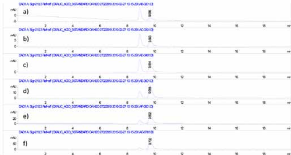
Rajah 4. Masa tahanan ( rt ) untuk standard asid oksalik dalam larutan air pada kepekatan berbeza, a) 6.125 ug/mL; b) 12.5 ug/mL; c) 25 ug/mL; d) 50 ug/mL; e) 100 ug/mL dan f) 200 ug/mL. Masa tahanan ( rt ) bagi standard asid oksalik dalam larutan air adalah pada 9.686 – 9.702 min
