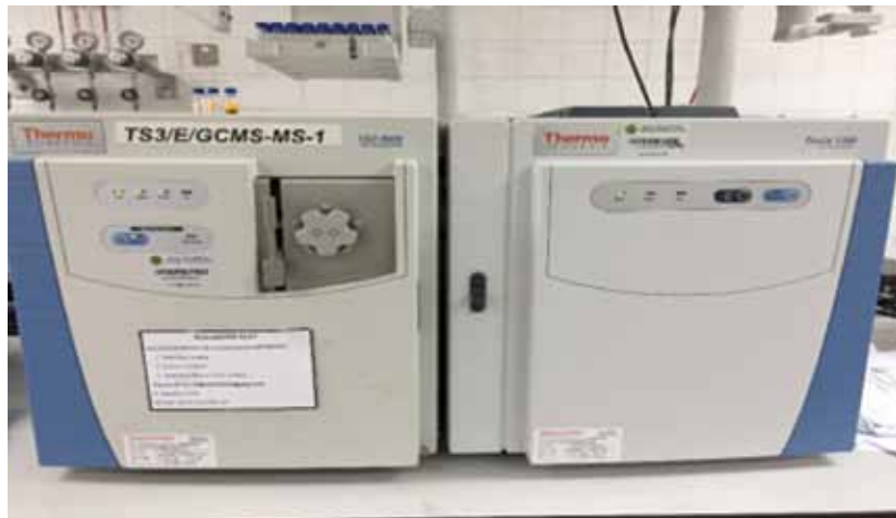
Gambar 3. Peralatan kromatografi gas spektrometri jisim (GCMS) yang digunakan bagi tujuan pengesanan dan pengenalpastian sebatian kimia fitosterol
