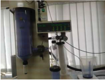
Gambar 3. Proses semburan kering dijalankan
