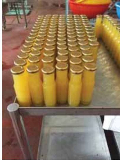
Gambar 2. Minuman jus nanas dibotolkan semasa masih panas ke dalam botol kaca 200 mL
