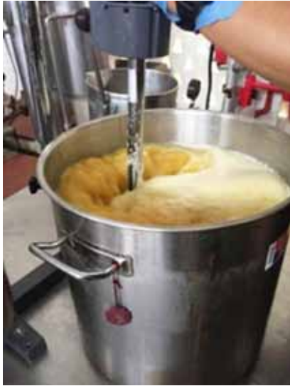
Gambar 1. Nanas yang telah dikupas dan dibasuh dikisar dengan menggunakan industrial juicer
