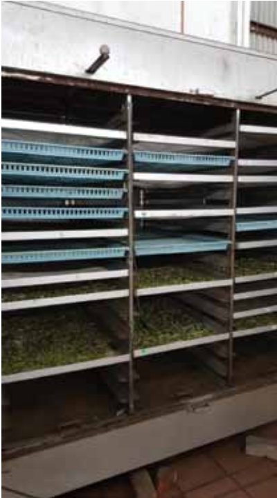
Gambar 1. Teknik pengeringan serabut dengan menggunakan kabinet pengeringan
