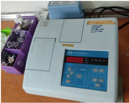
Gambar 5. Alat pengukur kekeruhan untuk mengukur nilai kekeruhan setiap sampel nisbah
