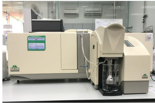
Gambar 6. Alat Particle Size Distributor yang digunakan untuk menganalisis saiz partikel sagu basah
