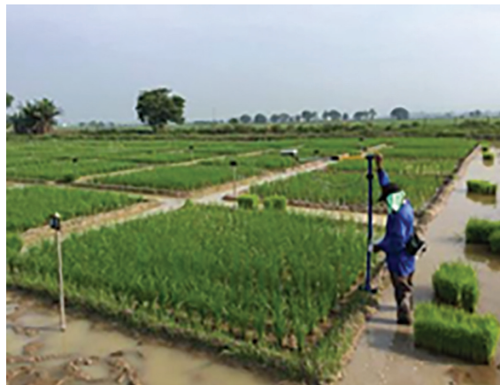
Gambar 2. Penderia Crop Circle ACS-430 dipasang pada sebatang tiang semasa data pada plot kajian diambil
