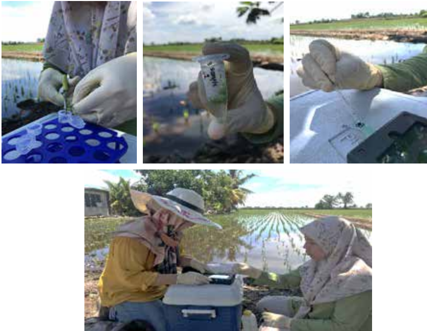
Gambar 5. Analisis sampel di lapangan menggunakan kaedah biosensor yang dibangunkan dengan teknik pengekstrakan sampel yang mudah
