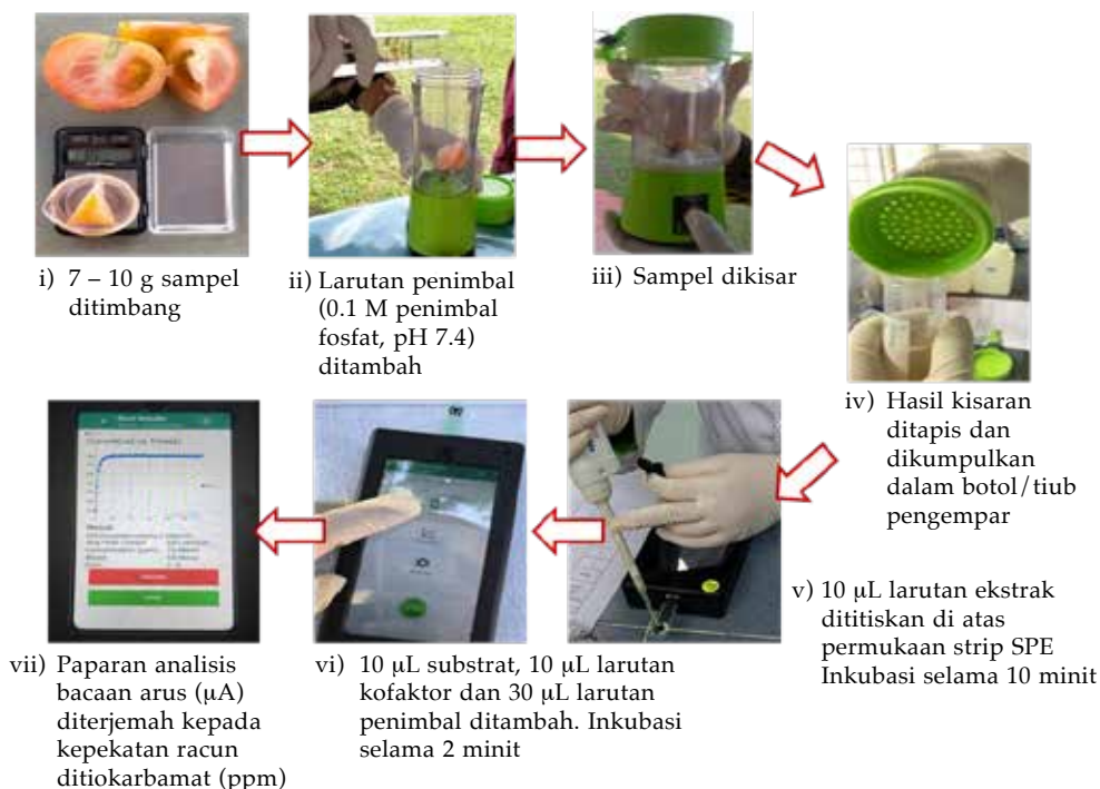
Gambar 4. Proses penyediaan sampel sayur-sayuran bagi pengesanan pantas racun ditiokarbamat menggunakan peranti mudah alih biosensor dengan IoT di lapangan
