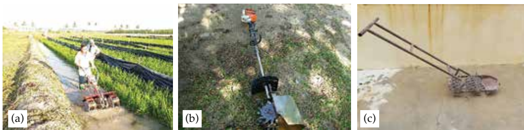
Gambar 5. Jenis-jenis weeder (a) yang dikendalikan secara manual, (b) berenjin jenis satu-roda, (c) berenjin jenis tiga roda
