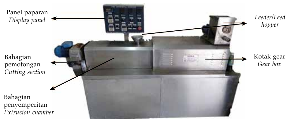
Gambar 1. Mesin penyemperitan kering yang mempunyai dua skru
