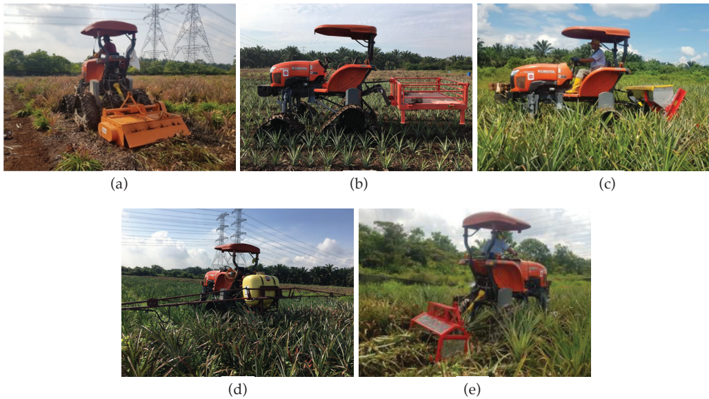
Gambar 4. Implemen untuk operasi pengeluaran nanas, (a) penghancur pokok, (b) treler gantung, (c) penabur baja, (d) penyembur bum, (e) pencantas pokok
