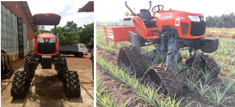
Gambar 3. Traktor telah diubah suai ketinggian kelegaan
