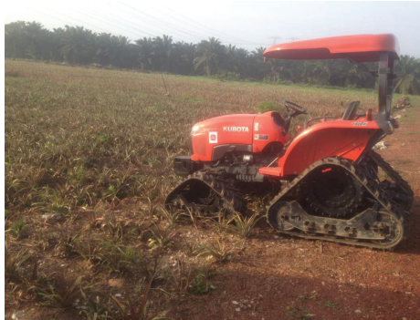
Gambar 1. Traktor yang telah ditukar dengan sistem trek
