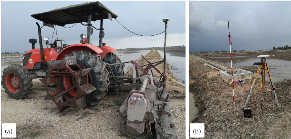
Gambar 1. (a) Penderia ketinggian tanah dipasang pada implemen dan traktor (b) Stesen pangkalan kinematik (RTK)
