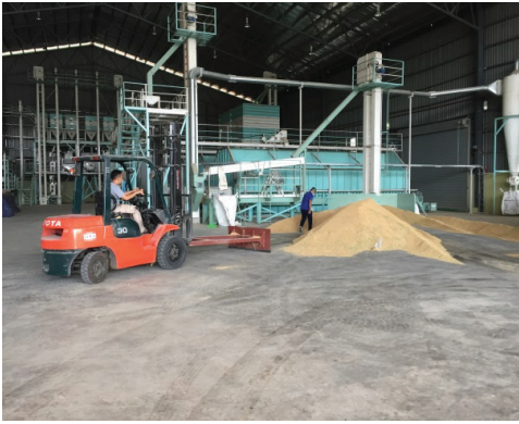
Gambar 2. Proses memasukkan padi ke dalam plenum IBD
