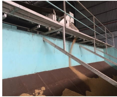
Gambar 3. Pergerakan discharge car untuk mengisi padi basah ke dalam IBD
