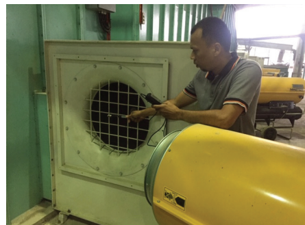
Gambar 4. Pengukuran halaju udara pada blower IBD menggunakan anemometer
