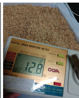
Gambar 6 . Alat moisture meter untuk mengukur kandungan kelembapan padi
