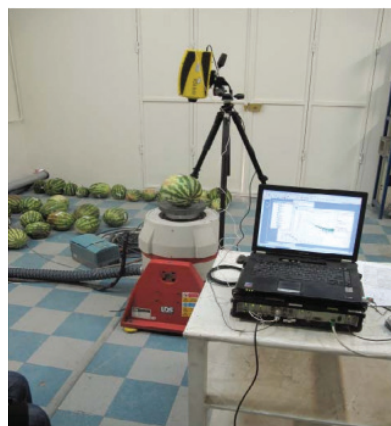
Gambar 6. Pengesanan tindak balas getaran melalui peralatan Laser Doppler Vibrometry pada permukaan luar tembikai sebagai signal output penentuan kematangan tembikai (Abbaszadeh et al. 2017)
