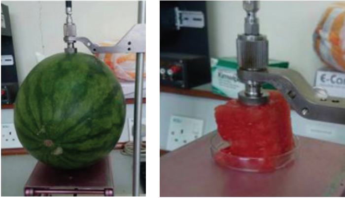
Gambar 8. Pengujian sifat dielektrik pada permukaan dan tisu dalam tembikai menggunakan peralatan elektronik dengan probe penerima koaksial terbuka (OEC)
