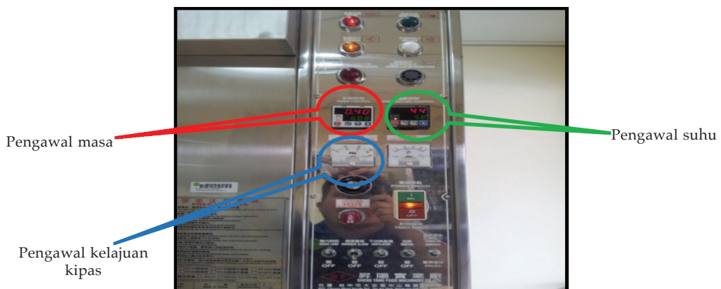
Gambar 5. Panel pengawal pada alat pengering kabinet
