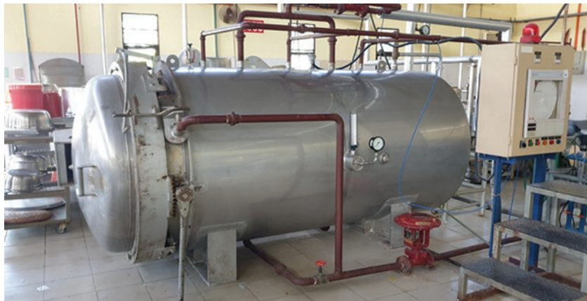
Gambar 3. Mesin retort horizontal untuk proses terma produk pengetinan
