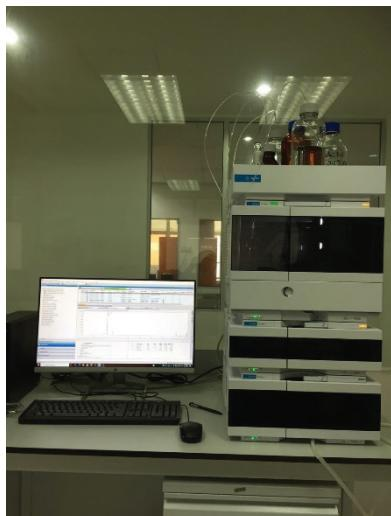
Gambar 6. Peralatan kromatografi cecair berprestasi tinggi (HPLC)
