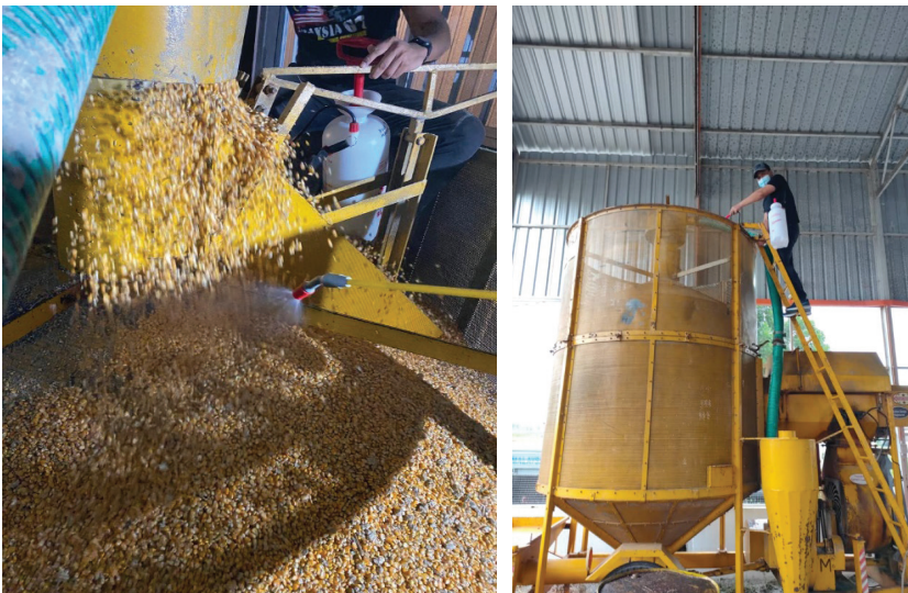
Gambar 4. Teknik penyemburan telah diaplikasikan di lapangan bagi menyembur larutan Agrozide™ ke atas jagung bijian. Penyemburan telah dilakukan semasa proses pengeringan
