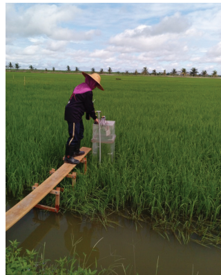
Gambar 2. Kedudukan ruangan tertutup ( closed chamber ) dan papan lapis berjalan di plot kajian
