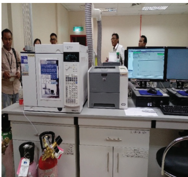
Gambar 4. Contoh instrumentasi kromatografi gas (GC) yang digunakan untuk pengesanan gas-gas
