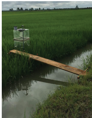
Gambar 2. Kedudukan ruangan tertutup ( closed chamber ) dan papan lapis berjalan di plot kajian
