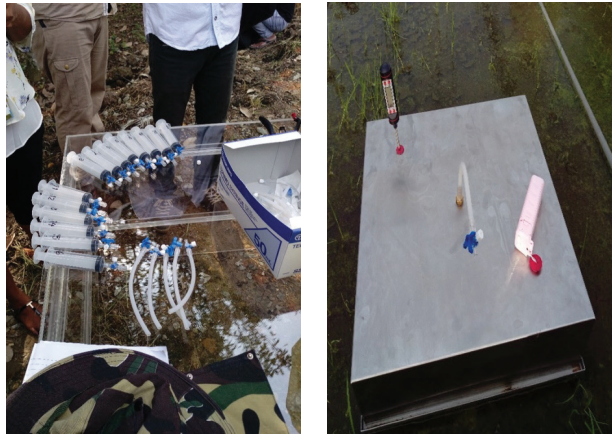
Gambar 3. Contoh picagari yang digunakan dan ruangan tertutup yang diperbuat daripada keluli tahan karat
