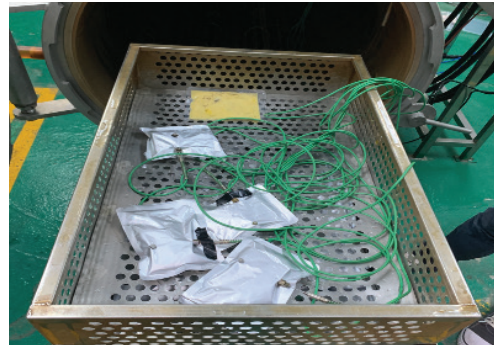
Gambar 2. Proses rawatan haba pes durian menggunakan mesin retort
