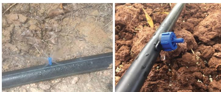
Gambar 8. Sistem pengairan jenis titisan seperti *spray jet* (kiri) dan *dripper* (kanan)
