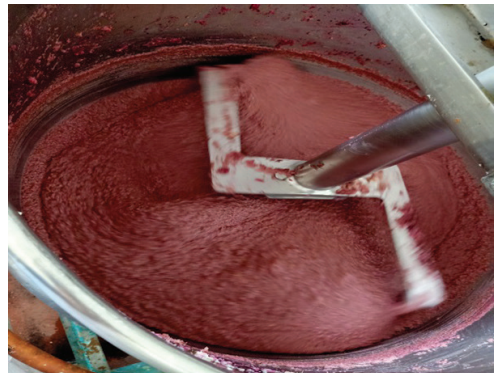
Gambar 4. Proses pengisaran bahan mentah sehingga menghasilkan pes campuran yang homogen
