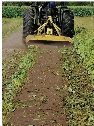
Gambar 2. Pemotongan jalar daun ubi keledek menggunakan mesin rumput sangkutan traktor
