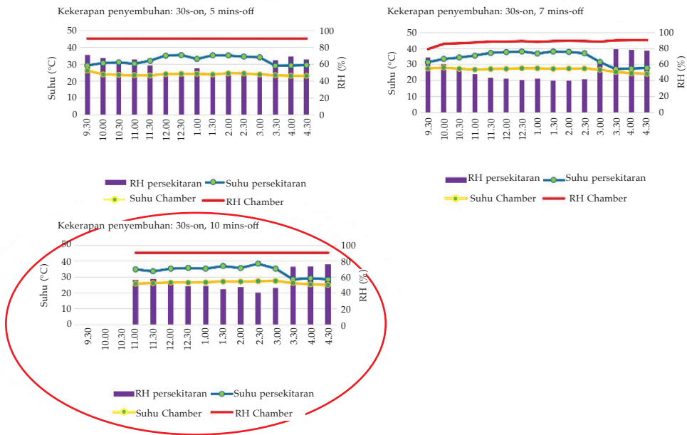
Rajah 2. Perbandingan data suhu dan kelembapan relatif persekitaran melawan suhu dan kelembapan relatif ruang pertumbuhan akar pada kekerapan penyemburan yang berbeza
