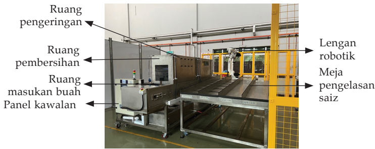
Gambar 1 Sistem pembersihan dan pengeluaran saiz tembikai yang dibangunkan oleh MARDI
