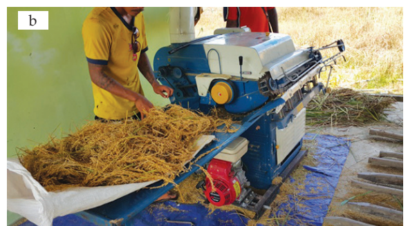
Gambar 5. Jentera yang digunakan bagi penuaian (a) Mini jentuai dan (b) Mesin pelerai
