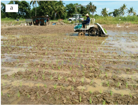
Gambar 3. Jentera yang digunakan bagi penanaman (a) Aktiviti penanaman menggunakan jentanam dan (b) Kawasan kajian yang telah ditanam menggunakan jentera
