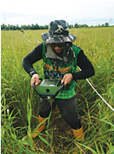
Gambar 1 . Aktiviti pensampelan keupayaan galas tanah menggunakan peralatan penetrologger Eijkelkamp
