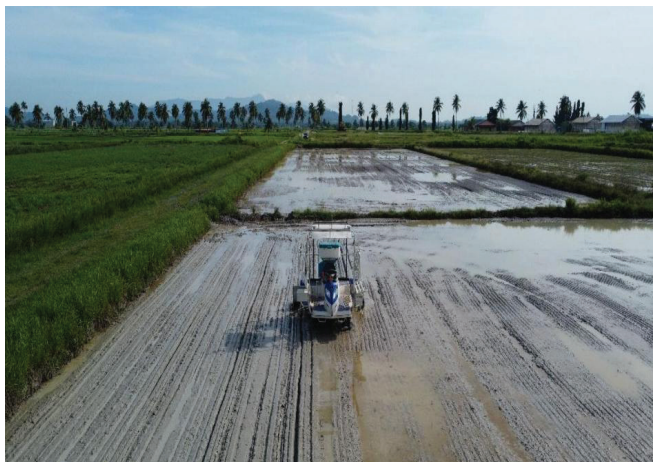
Gambar 1. Penaburan benih menggunakan Penabur Benih Autonomi
