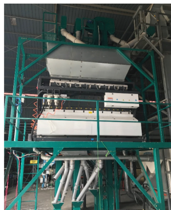
Gambar 2. Pengisih warna optik berkapasiti 1 – 3 tan/jam
