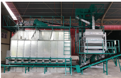
Gambar 1. Pengering kebuk condong berskala kecil berkapasiti 6 tan/kelompok pemprosesan
