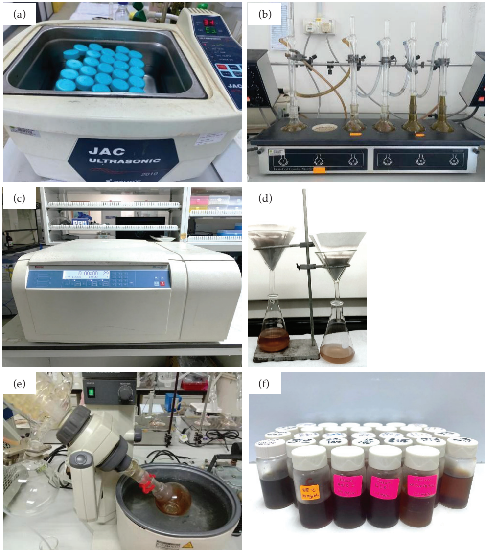
Gambar 4. (a) Pengekstrakan menggunakan mesin ultrasonik, (b) Pengekstrakan menggunakan sistem Soxhlet, (c) Pengasingan supernatan daripada sedimen menggunakan pengempar, (d) Penapisan ekstrak menggunakan kertas turas, (e) Pemekatan ekstrak menggunakan penyejat berputar dan (f) Hasil akhir ekstrak kesum
